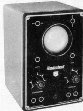
Zusatz-Oszillograph für Abgleich-Arbeiten zusammen mit AM/FM-Signal-Generator MS-5. Aufbau des Meßplatzes lediglich durch Einführen des vorbereiteten, mitgelieferten Mehrfachkabels in die hierfür vorgesehene Steckfassung am MS-5, womit alle Verbindungen automatisch und fehlerfrei hergestellt sind
