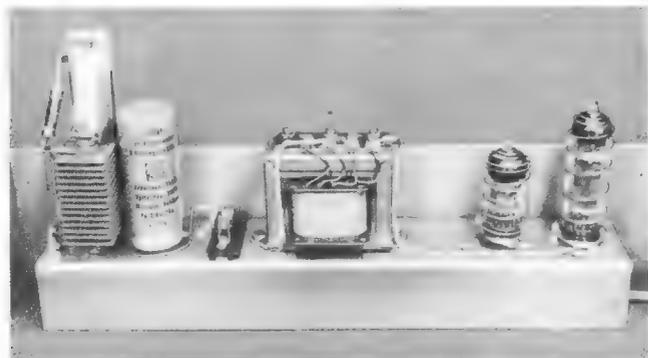
Bild 2. Ansicht des Verstärkerchassis, der Ausgangstransformator befindet sich genau in der Mitte
