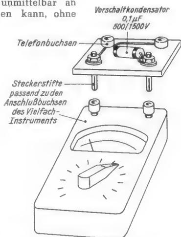
Eine praktische Ausführungsform für das Aufsteckbrettchen mit dem Vorschaltkondensator
