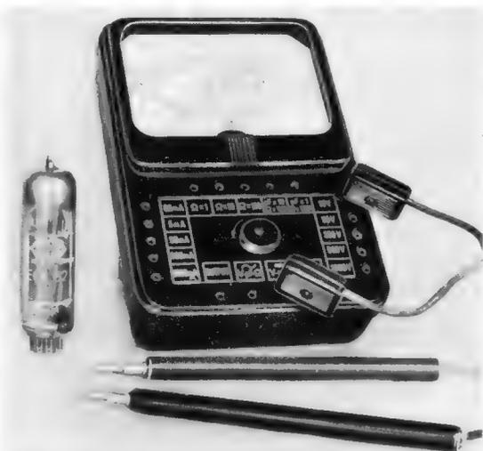
Das Universal-Taschenmeßgerät mit den Prüflleitungen im Vergleich zur Größe einer Röhre
