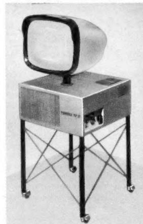
Neuartiges italienisches Fernsehgerät mit getrennt und beweglich angebrachter 43-cm-Bildröhre (Phonola)
