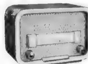
selbständiger UKW-Super, anschlussfähig an jeden Empfänger ohne UKW-Teil in schönem Gehäuse. Hohe Empfangsleistung mit Netzanschluß 125-220 V Wechselstrom. Ohne Lautsprecher und NF Teil. Röh. ECC 81, EF 85, EF 85, EAA 91 und Radiodetektor. 9 Kr., Wellenber. 87-100 MHz. UKW-Dipolantenne 300  $\Omega$
