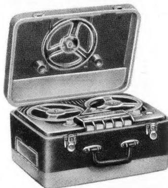
Tonband-Koffergerät mit 5 Drucktasten (Aufn., schneller Vorlauf, Halt, schneller Rücklauf, Wiedergabe) Bandgeschw. 19 cm/sec. Doppelspur. Kombin. Aufn.- und Wiedergabekopf, HF-Löschkopf und Vormagnet. Eingeb. Endstufe mit Kontroll-Lautsprecher, Aussteuerung d. Mag. Auge. Autom. Löschsperre. Anschluß für Mikrofon und Tonabnehmer für 350 m LA und 500 m LA-Band. Laufzeit für 350 m  $2 \times 30$  Min. Frequenzbereich 40-12000 Hz. Rö. EF 86, ECC 81, EL 84, EM 11 und Gleichrichter . . . . . DM 398.—
